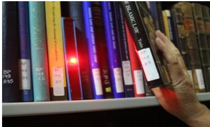
تصویر ۱- آزمون اولین نمونه دستگاه جایزها در مخزن و قرار دادن آن به جای کتاب بر روی قفسه
