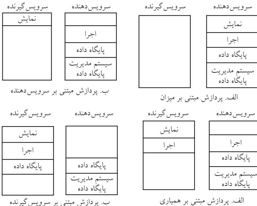
شکل ۳. مدل‌های معماری سرویس دهنده/ سرویس گیرنده (۱)
